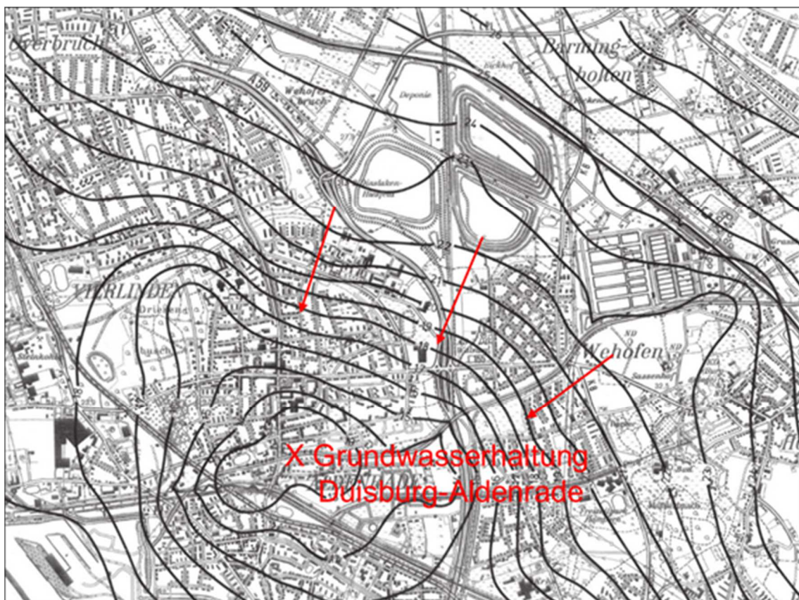
Abb. 2: Grundwassergleichen in mNN (Stichtagsmessung April 2016) Quelle: Emschergenossenschaft.
